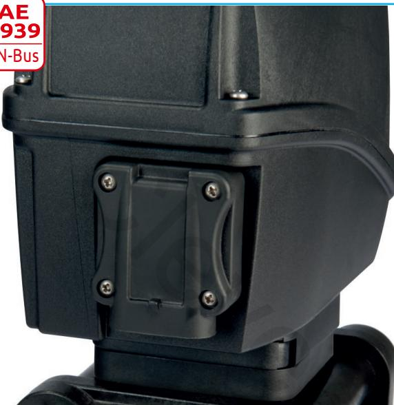
Le valvole a sfera serie 853 con collegamento **CAN-Bus** sono dotate di un apposito connettore **Tyco Superseal®** a 4 poli con innesto a pressione. All'interno l'elettronica è in grado di gestire la rotazione della sfera a passi di 1°. Il sensore rileva la posizione della sfera e fornisce al dispositivo (collegato tramite la porta di comunicazione CAN-Bus) precise indicazioni sul movimento della stessa, in tempo reale.
